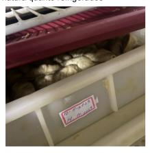
Geladeira com borracha danificada, impedindo seu fechamento correto. Verifico temperatura acima do indicado. Ação corretiva: manutenção assim que possível e realocar produtos em outro local de refrigeração com temperatura adequada.
